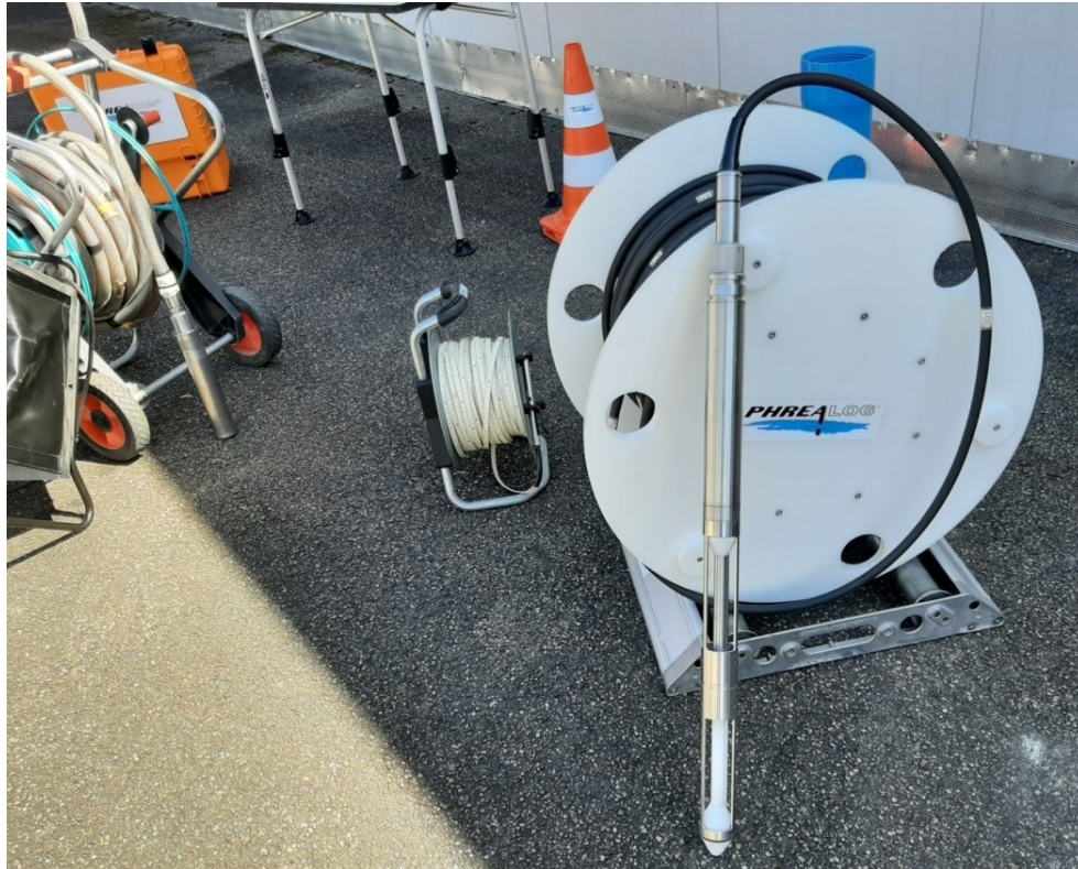
Fließmesssonde mit 100m Kabeltrommel mit MP1 Equipment zur Messung unter hydraulisch angeregten Fließverhältnissen
