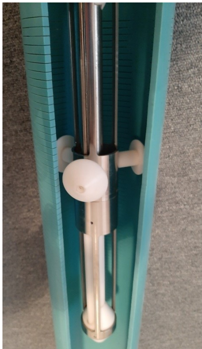
Führung der Sonde mit Zentrierern in Brunnenrohr
