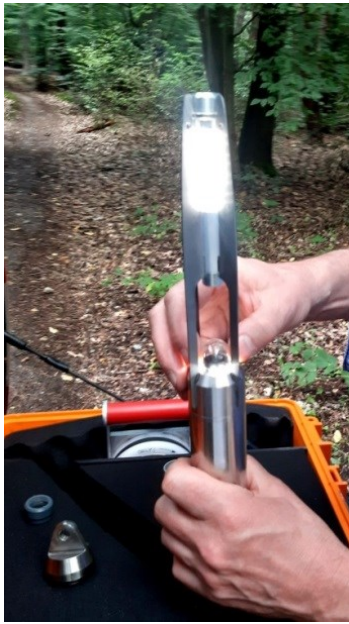
Beleuchtungsaufsatz für Messstellen größer 10-Zoll (DN250)
